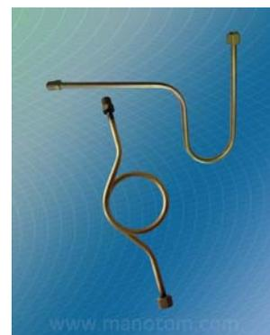
Устройства охлаждения (охладители) предназначены для предохранения манометров, и измеряющих давление пара, горячей жидкости и других измеряемых сред, имеющих температуру выше плюс 60°C от непосредственного действия горячей среды.
