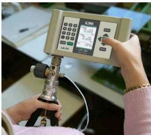
Калибратор LPC 300 с ручным прессом LPP
